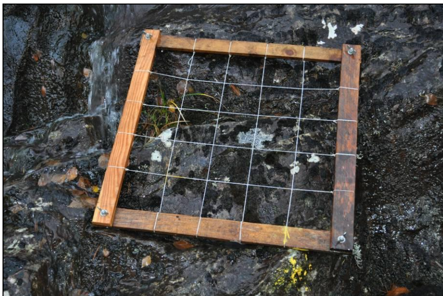
Figur 4.7. Analyserute 1 ved Svelgen. Rammen ble lagt så at nedre kanten har støtte fra en liten sprekk/hylle i berget. Merk gul farge-markering.
